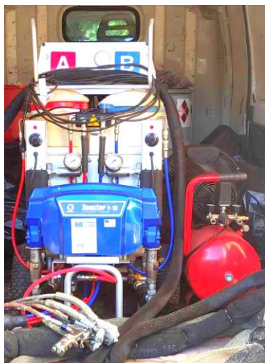
Nuotraukose įsigyta nauja šiltinimo purškiamu putų poliuretano įranga ir vykdomi pastato šiltinimo darbai.
